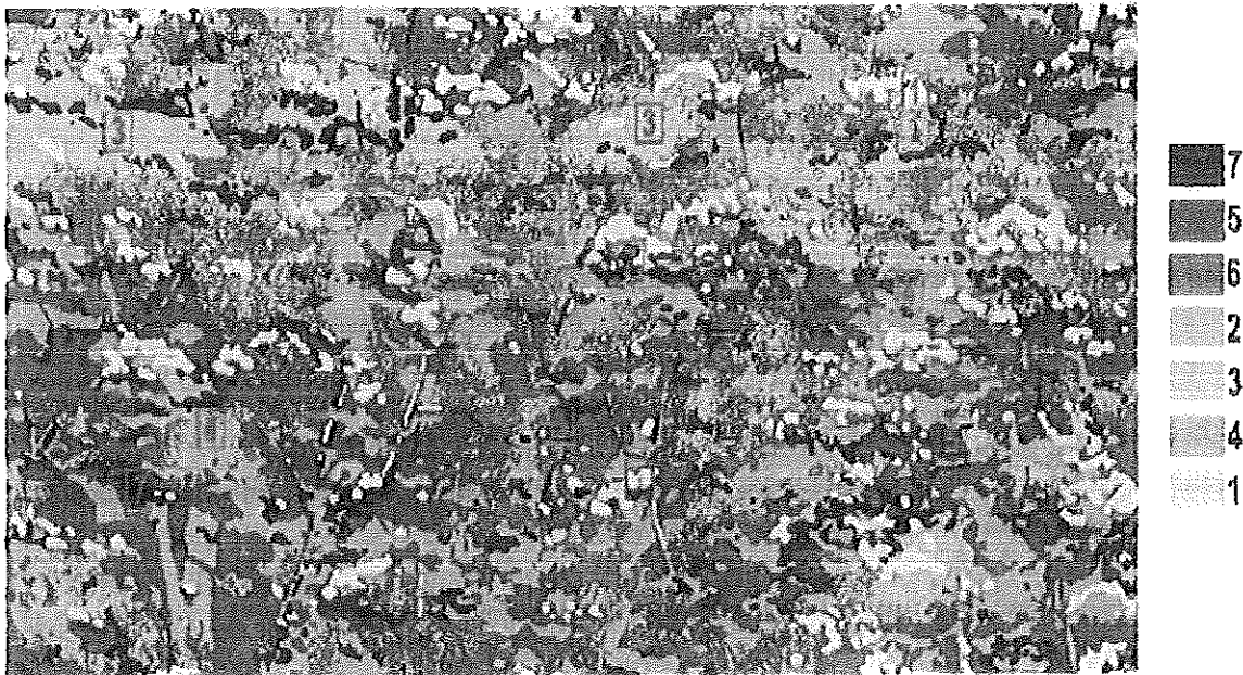
Rys.3. Miejsca pomiaru zgodności barwy z wzorcem dla poszczególnych kolorów.
